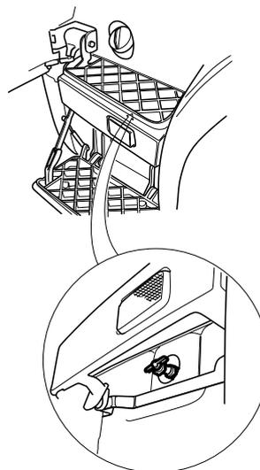
En el cuadro de instrumentos debajo de mando del freno de estacionamiento, hay un racor de aire que se utiliza para reponer aire en el circuito del freno de estacionamiento, por ejemplo, en caso de remolcado.
