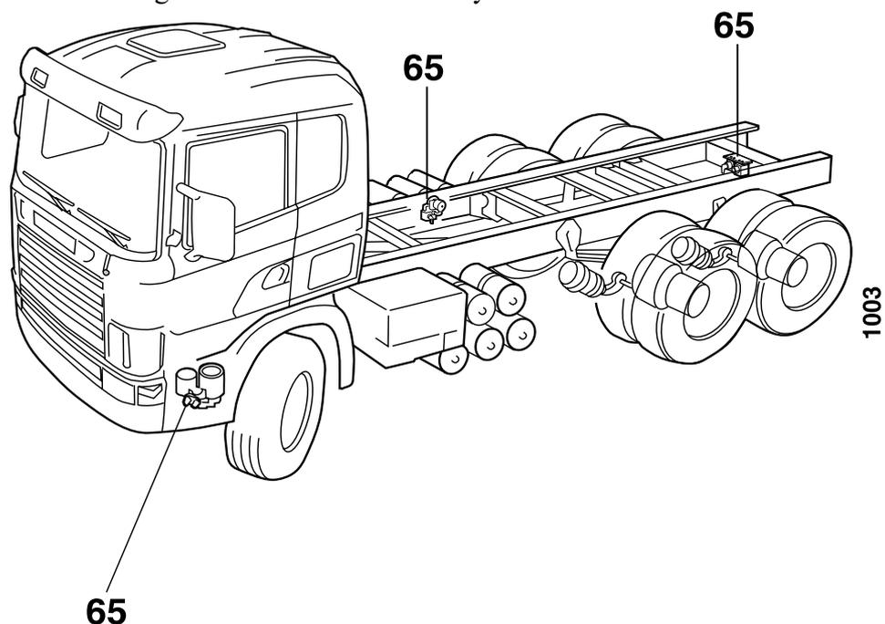
Hay espacio para válvulas solenoide adicionales en el soporte de válvulas solenoide ubicado en uno de los travesaños junto al bogie o el eje trasero. Las válvulas y los acoplamientos pueden adquirirse de los distribuidores de Scania.
