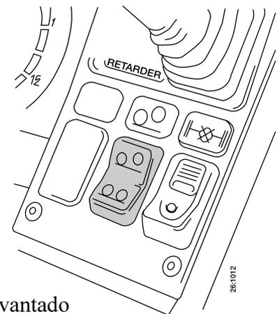
Eje portador levantado
